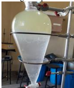
Figura 4 – Lavagem aquosa do sebo bovino
